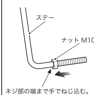
**4** 図のようにウインドシールドのブラケットをゆるめて、左右のステーに差し込みます。
