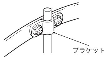
左右のステーを固定するときは、キャップナット M10 を手でいっぱいまで締め付けてからナット M10 をスパナで締め付けてください。
